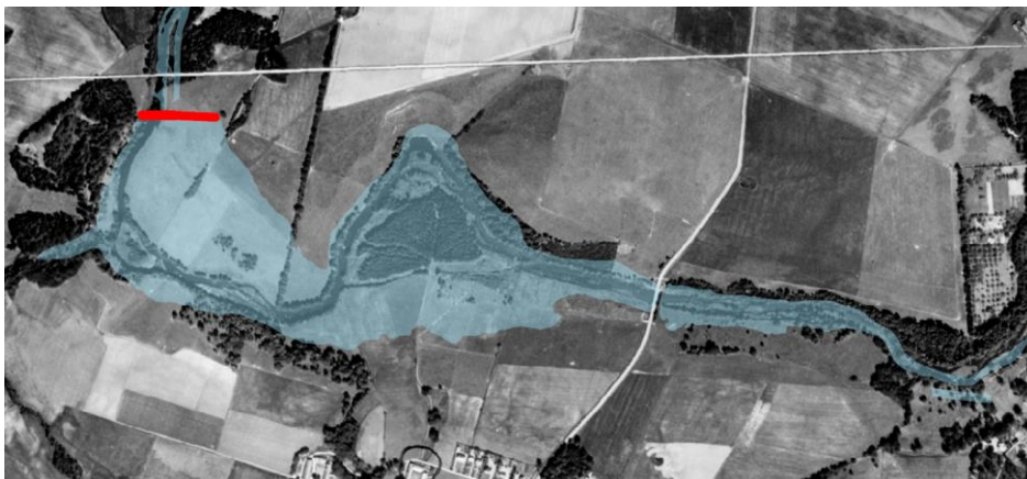
Figur 27. Åfåran vid Stackarp innan indämning. Nuvarande magasin markerat i ljusblått och ursprunglig åfåra i mörkare blått. Målbilden är att återställa åfårans läge till dessa ursprungliga förhållanden.
